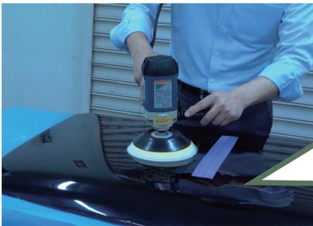
04 シングルアクションポリッシャー（パッド径148mm）を使って#4000のペーパー目を消す。回転数は終始低速（1,000rpm以下）に設定し、パフを押し付け過ぎないようにして当てる
